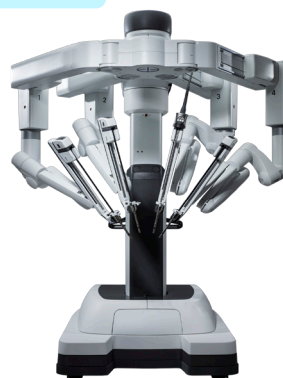
ペイシェントカート (ロボット機器と接続)
