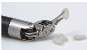
微細な先端のロボット機器 手ブレのない繊細な動きが可能
