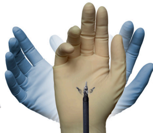
自由度の高いロボット機器 (7関節) 人間の手以上の可動域 (270°)
