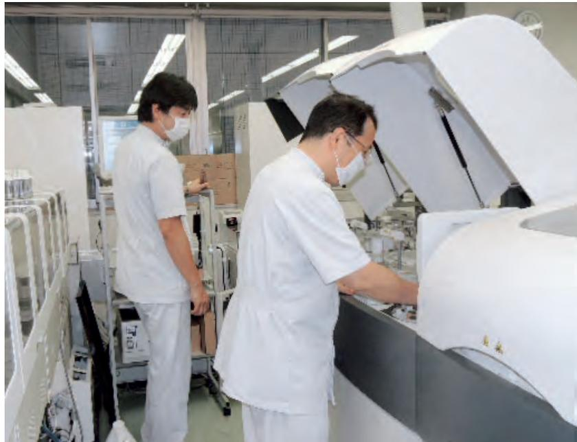
①生化学自動分析機 4,800項目/毎時、処理します。このクラスでは最速の分析機です。
